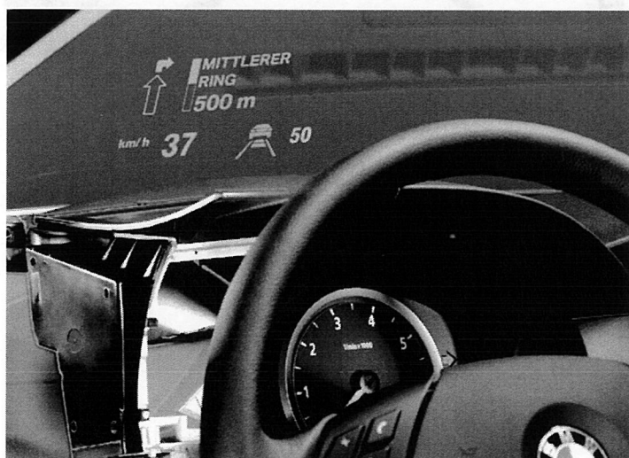
図 4-18 自動車用 HUD turn by turn 表示や先行車車間表示像が見える (BMW 社の次世代 HUD, カタログより, 2004)
