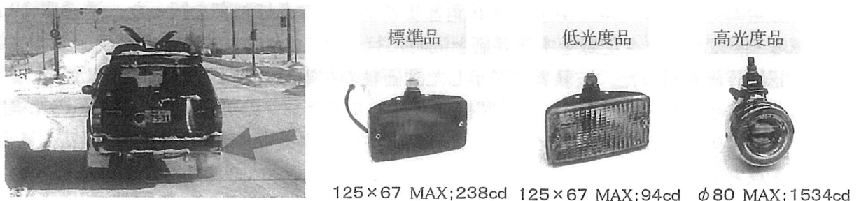
図 5. 2. 4-3 実験に使用したリアフォグランプと実験車への取付け状況
