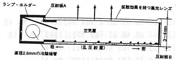
図 6-1 空洞方式のバックライトの構造 1,4)
