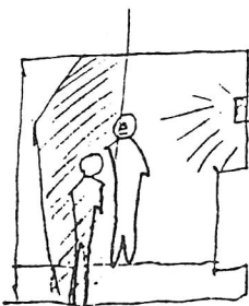
(間接照明) (ブラケット照明) 玄関の照明
