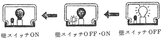
図9.16 常夜灯付新型廊下灯
